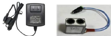
AC(100-240V)-DC12V 変圧器 50-60℃保温用 5ml Tubeアルミブロックヒーター 50-60℃でたんぱく処理するための保温機器 (車の12Vの電源を使用して55℃前後で保温)
